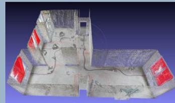
Система собственной разработки производит сканирование объекта при обходе оператором и позволяет создавать высокоточные трехмерные цифровые двойники различных пространств. На основе 3D-моделей строящегося объекта и проектной BIM-модели "Умный контролёр стройки" при помощи ИИ в автоматическом режиме отслеживает, анализирует и прогнозирует весь строительный процесс, как на предмет задействованных стройматериалов на каждом этапе, так и завершение сроков строительства всего проекта.
