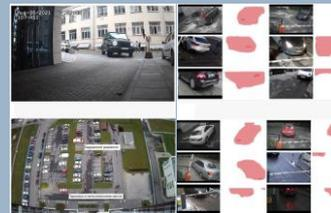
Система решает одну из основных проблем застройщиков и УК ЖК - отсутствие учета проезда и парковки автомобилей. Программный комплекс анализирует и распознает автомобили при проезде шлагбаума / ворот, анализирует положение машин и распознает неправильную парковку (нарушил разметку / занял чужое место / стоит слишком долго и т.д.). Распознавание занимает не более 0.2 секунды.
